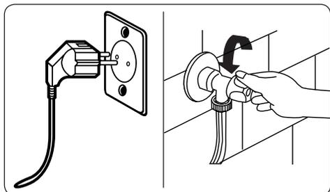
Desligue a alimentação elétrica principal e retire a ficha da tomada antes de realizar a manutenção e a limpeza da sua máquina.
